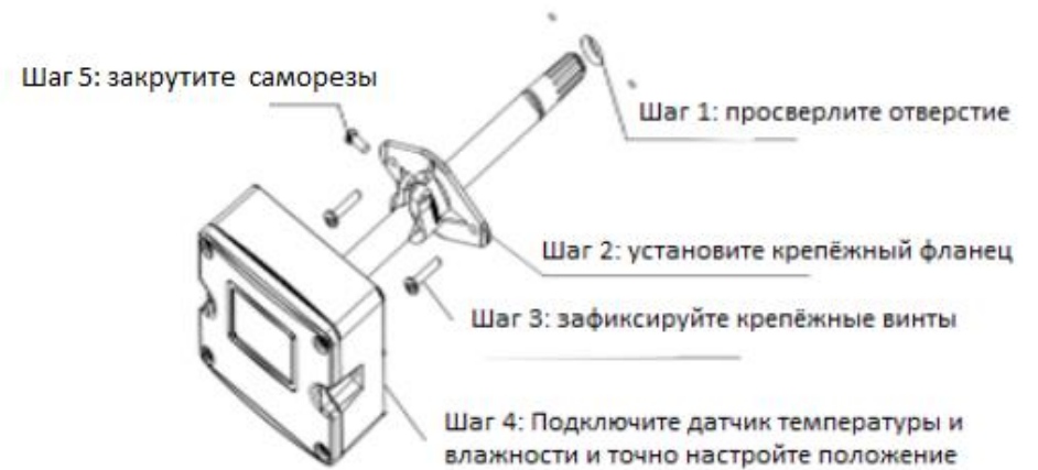
LFH102 Схема установки
