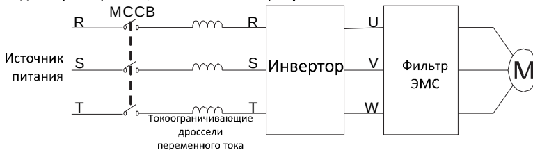
Рисунок 4.17. Электромонтаж силовой цепи электродвигателя
