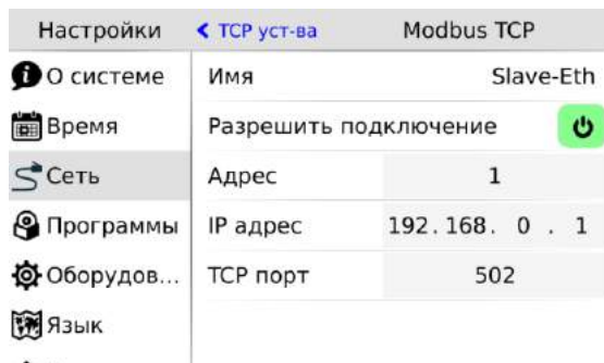
Рис. 56 – Настройку Modbus TCP slave
