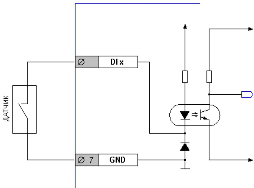
Рис. 32 - Схема (условная) дискретного входа
