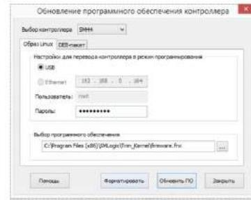
Рис. 94 - Окно выбора параметров обновления ПО
