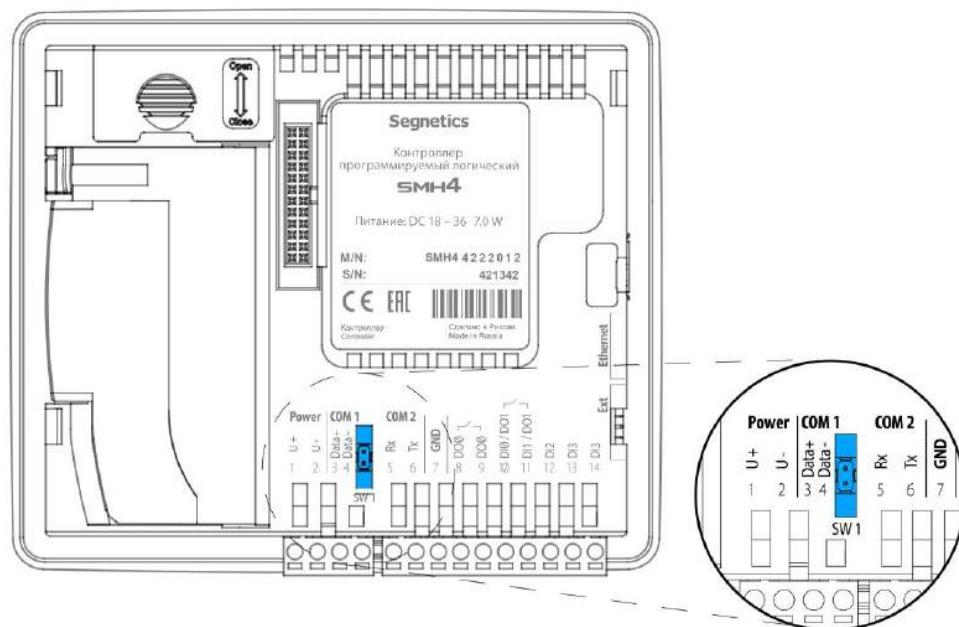
Рис. 42 Подключение согласующего резистора на контроллере SMH4 - XXXX-XX-X
