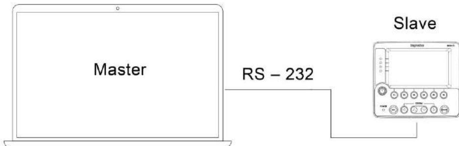
Рис. 44 – Подключение контроллера по RS-232-
