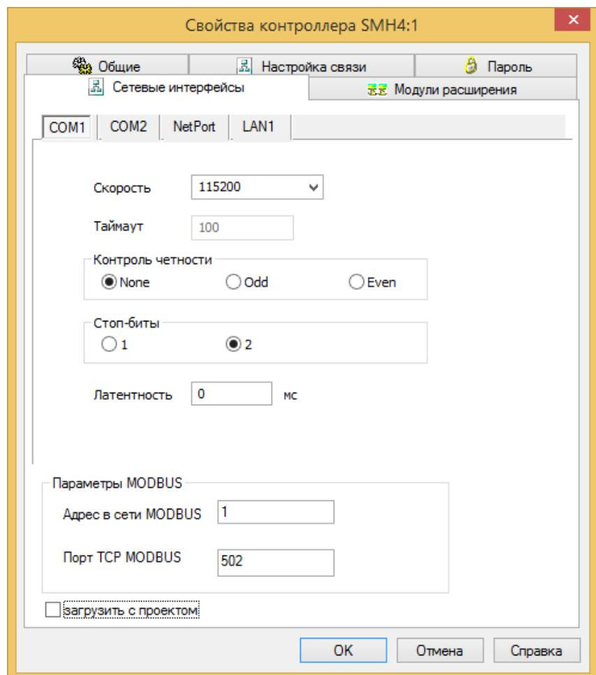
Рис. 47 – Окно задания параметров работы в режиме Slave по RS232
