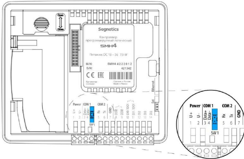
Рис. 13 Согласование интерфейса RS-485 на контроллере SMH4 - XXXX-XX-X
