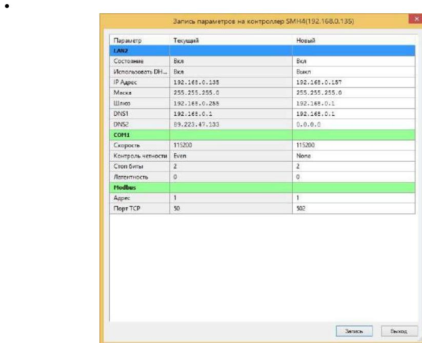
Рис. 49 – Окно записи параметров работы в режиме “Slave” на контроллер
