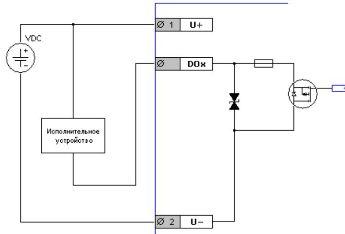
Рис. 38 -Транзисторный выход. Питание контроллера и исполнительного устройства от одного источника тока
