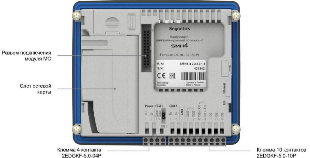
Рис. 3 – Задняя часть контроллера
