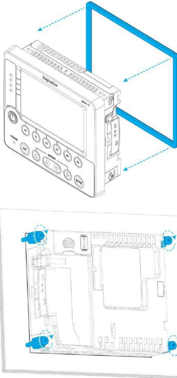
Рис. 22 –Монтаж на дверцу шкафа
