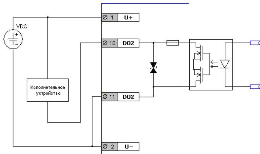
Рис. 39 - Опторелейный выход. Питание контроллера и исполнительного устройства от одного источника тока
