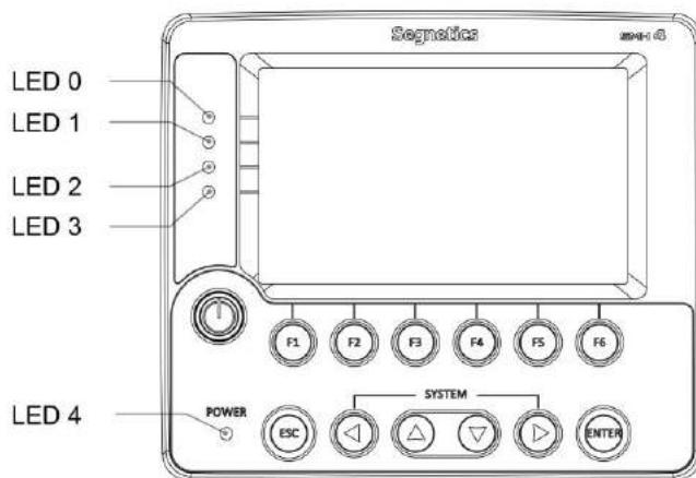
Рис. 12 – Светодиодная индикация
