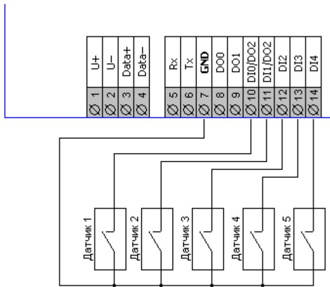
Рис. 33 - Подключение датчиков типа «сухой контакт»
