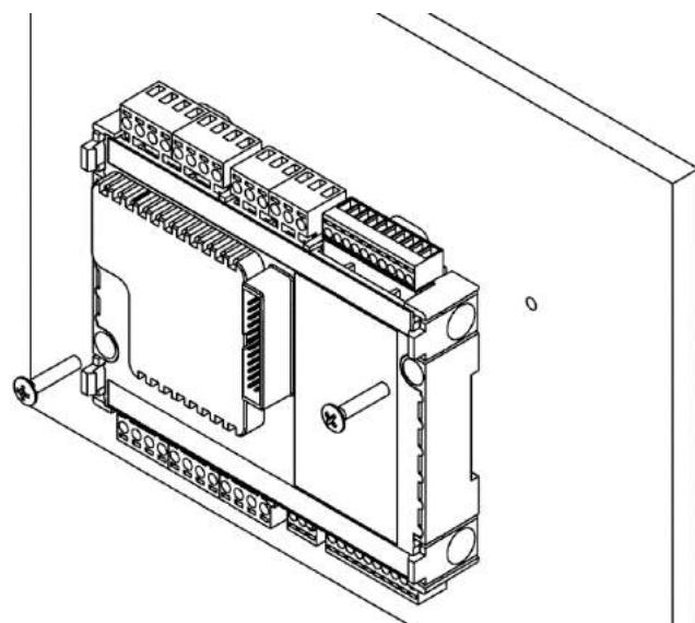
Рис. 20—Фиксация модуля MC к панели винтами
