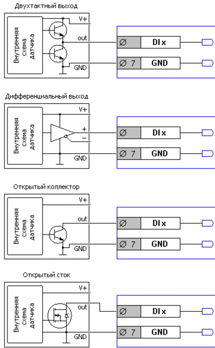
Рис. 34 -Схемы подключения датчиков с различными типами выходов
