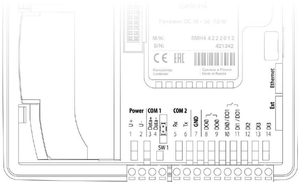
Рис. 24 – Вид контроллера со стороны маркировки клемм
