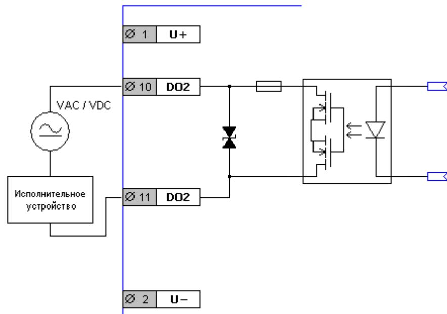
Рис. 36 Схема (условная) релейного выхода
