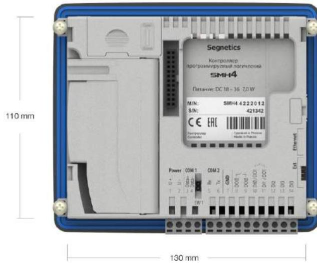
Рис. 7 – Установочные размеры контроллера
