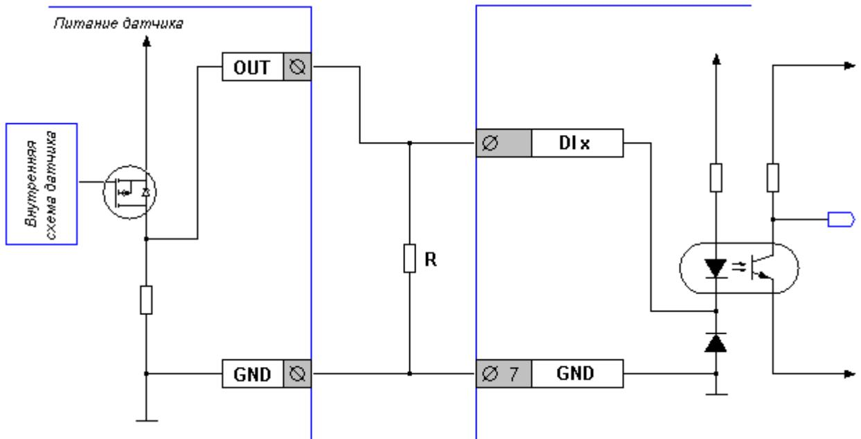
Рис. 35 - Подключение датчиков с выходом «PNP»
