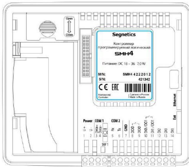
Рис. 1 - Расположение маркировки на задней крышки SMH4 - XXXX-XX-X
