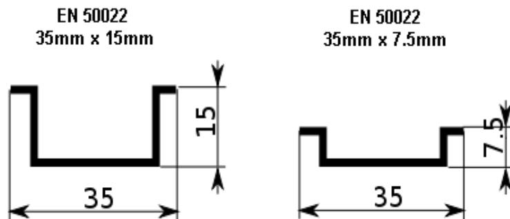
Рис. 17—Варианты DIN-рейек для монтажа
